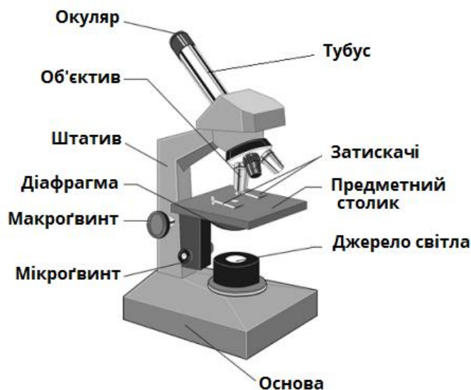
Рис. Будова мікроскопа.
